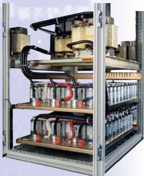
Filtros automáticos con tiristores para cargas dinámicas. Automatic harmonic filters with zero-cross switching thyristors for dynamic loads.
